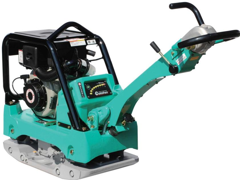
転圧センサー(Compas)は起振体部に設置した加速度センサーにより、地盤剛性値を定量的に確認できるため、より効率的な転圧作業を可能とします。
